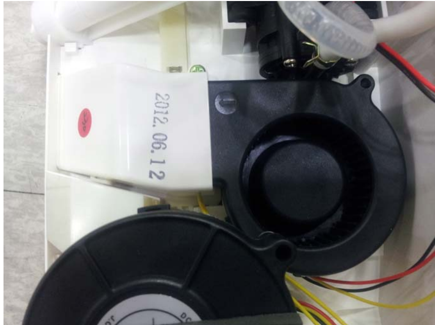
Dry fan motor
